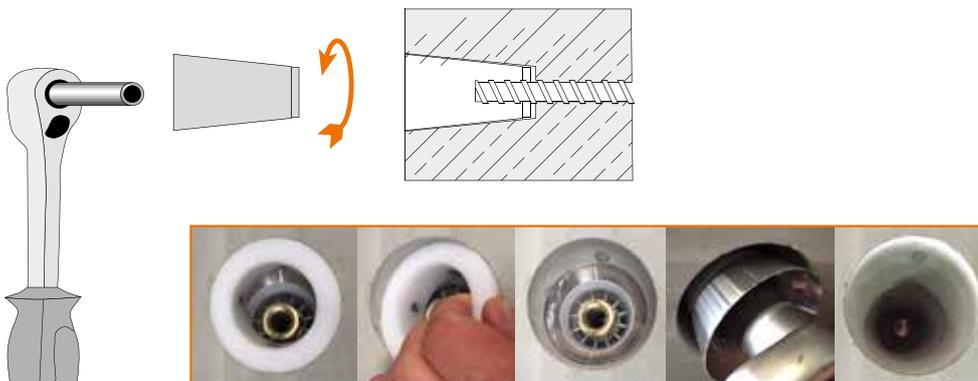
**Der Verschlusskonus VK-STKK** wird zum Verschließen der Konenlöcher im Beton verwendet. Abmessungen  $\text{Ø}58$  auf  $\text{Ø}48$  mm, Länge = 50 mm. **Der Hakenschlüssel** wird zum Eindrehen der VK-STKK 15/50 Ig mit Innengewinde benötigt.
