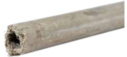
Die **Faserbeton-Distanzrohre** können werkseitig auf eine Fixlänge zugeschnitten werden. Bei der Ermittlung der Länge ist vorab die Auswahl der Dichtungskappe zu treffen. Für das FB-Rohr 22/40 gibt es ein großes Sortiment an Standardlängen.
