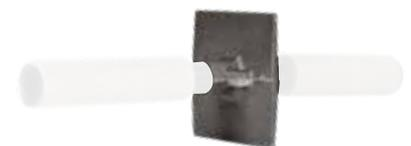
Das **Muffenstück KM** dient als Verbindungsstück zwischen der Gusswassersperre (WSG 15,0 oder WSS 15,0) und dem Faserbetonrohr mit Innendurchmesser 22 mm. Abmessungen Innen-Ø 22, Außen-Ø 26 mm.
